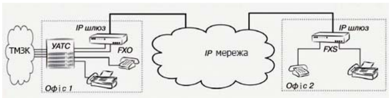
Рисунок 1.1 - Загальний принцип дії телефонних шлюзів IP-телефонії
