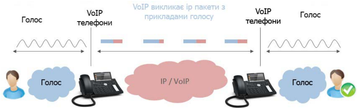
Рисунок 1.4 - Принцип роботи IP-телефонії
