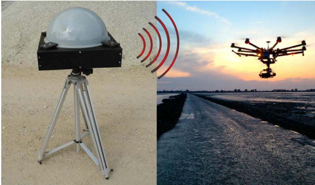
Рис 1.6. Акустичний детектор з одним мікрофоном
