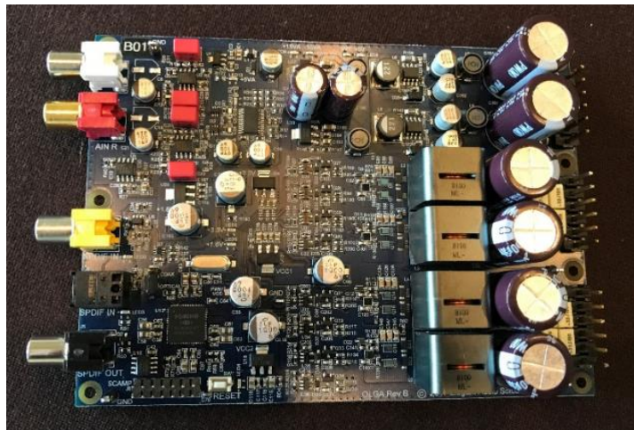
Рисунок 2.13 – Плата підсилювача EPC GaN FET Open-Loop Class D Amplifier PCBA
