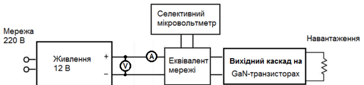
Рисунок 4.4 – Блок-схема випробувального стенду
