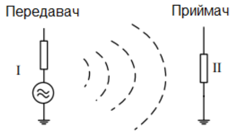
Рисунок 3.2 – Умовний шлях поширення електромагнітних завад у довкіллі [26]
